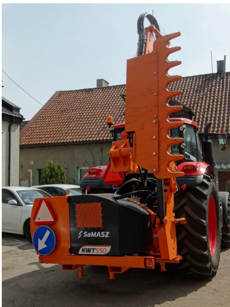
Kosiarka posiadająca głowicę do przycinania gałęzi o średnicy do 10 cm
